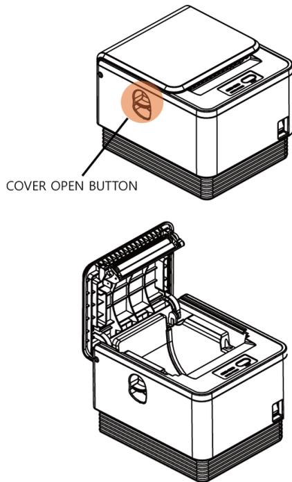
A7 Printer는 jam-free 프린터로 jam이 걸리면, 커버오픈 버튼을 눌러 프린터 커버를 오픈하면 자동으로 jam발생용지가 제거됩니다.
